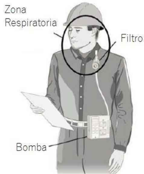
Fuente: SKC Limited. **Figura 6.2 - Elementos de un sistema de muestreo.**
